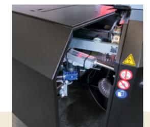
Große Maschinentür – ideal für Sägeblattwechsel und Reinigung.
