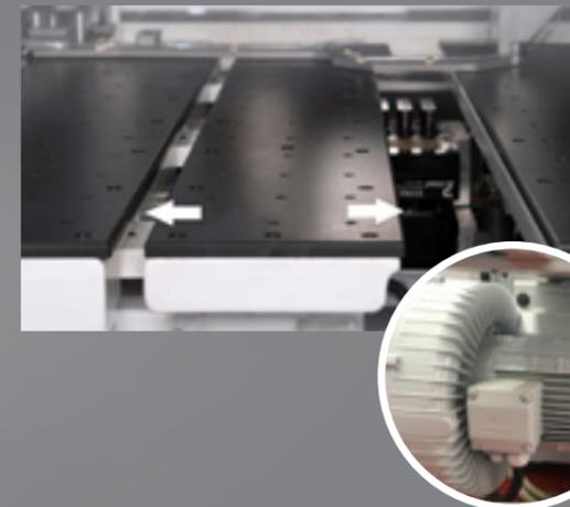
**Automatisch gesteuerte Luftkissentische** unterstützen das Werkstück optimal im Bearbeitungsbereich. Der Tisch bewegt sich nach links oder rechts je nach Anforderung.
