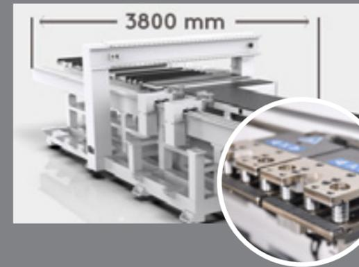
Das **Maschinenbett** wurde für maximale Belastungen konstruiert, der geschweißte Rahmen wurde getempert (Wärmebehandlung) um Spannungen zu entfernen.
