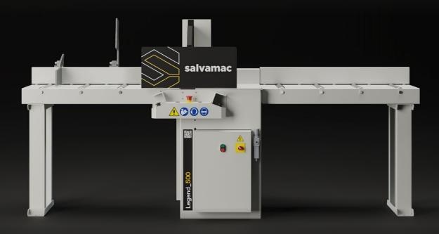
Halbautomatische Kappsäge für schnelles, sicheres und genaues Ablängen bis zu 125 mm Schnitttiefe.
