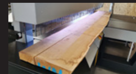
Überlange Massivholz-Bohlen können durchgeschoben und dank Druckbalken präzise gesägt werden
