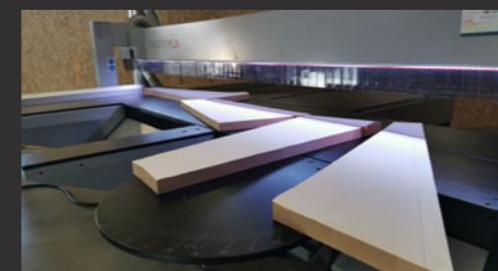
Treppenstufen mit unterschiedlichen Sägewinkeln mit Schnittlinienlaser in einem Durchgang sägen
