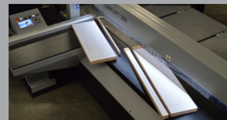
Statusanzeige Weiß: Werkstücke können positioniert werden
